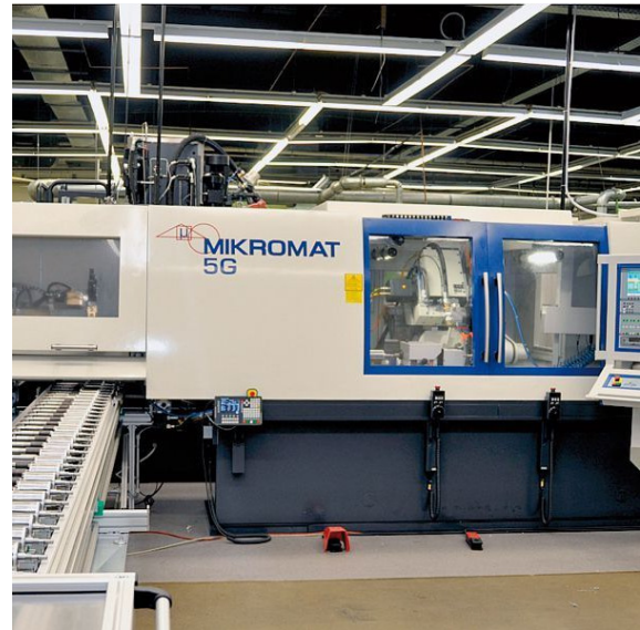
Neue Mikromat-Baureihe von 5G-Rotations-Formschleifmaschinen; Flexibilität, Universalität und Produktivität standen bei der Konzeption im Vordergrund. (Bild: Mikromat)
